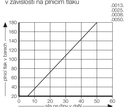
Počáteční síla plynové pružiny v závislosti na plnicím tlaku
